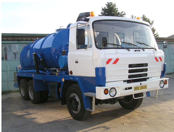
Ilustrační foto námi provedeného vozidla T815 CAS 11 po generální opravě (s novou nástavbou)
